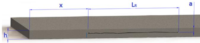
**Figure 2.** Longitudinal crack
