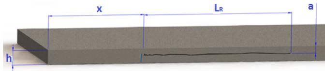
**Figure 2.** Longitudinal crack
